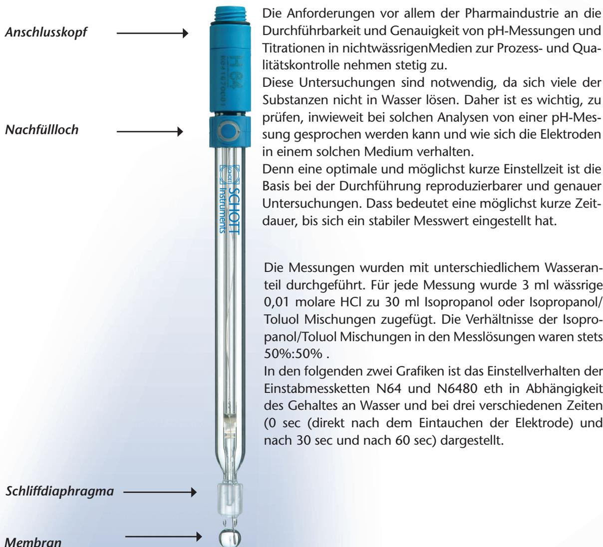
Abb. 1 pH Elektrode
